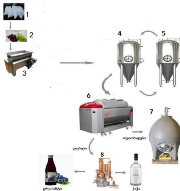
ნახ. 1. წითელი ყურძნის კომპლექსური გადამამუშავების ტექნოლოგიური პროცესის სქემა: 1 – ყურძნის დაყოვნება პოლიეთილენის ტომრებში; 2 – ყურძნის რეცხვა; 3 – ყურძნის კლერტგაცლა; 4, 5 – ყურძნის დუღილი დელესტაჟის მეთოდით; 6 – დურდოს გამოწნეხა; 7 – თვითნადენი ღვინის შემკრები; 8 – დურდოს გამოსხა
